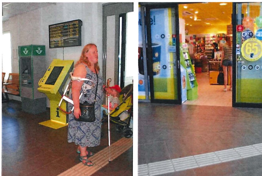
Figur 44: Ledstråk saknas till en informationsapparat och biljettautomat samt till Pressbyrån.
